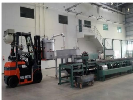
③ การดันด้วยอากาศ เพื่อถ่าย อะลูมิเนียมเหลวออกจากกา
