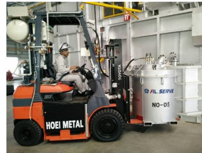
② การใช้ระบบสุญญากาศ ในการสูบอะลูมิเนียมเหลวเข้ากา
